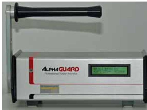
Abb. 5.2.2 Radonmessgerät für Sanierungen
