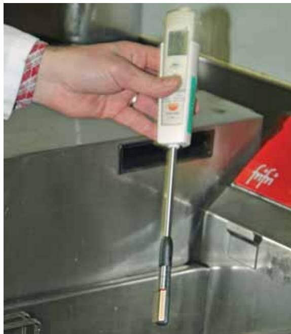
Abb. 4.7.1 Messung der polaren Anteile von Frittieröl mit einem portablen Gerät
