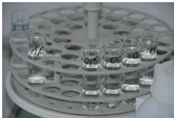
Abb. 4.13.3 Probensammler für die Untersuchung von Quecksilber
